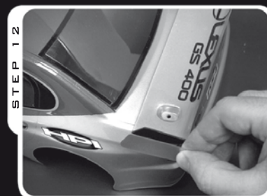
STEP 12 Attach wing with double-sided tape (HPI Part# 6163). 強力両面テープ (HPI品番6163) でウィングにサイドプレートを取り付けます。
