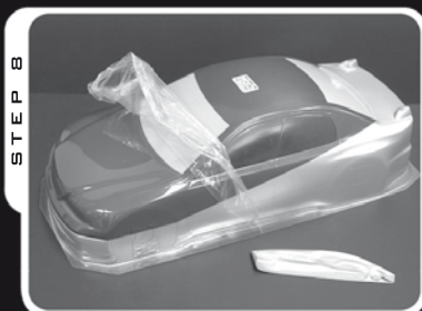
STEP 8 Let paint dry, remove protection film & window masks. 塗料を乾燥させ、保護フィルムやウィンドウマスクを剥がしてください。
