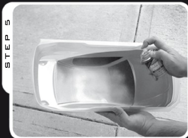
STEP 5 Remove tape for stripes, then spray. 乾燥後マスキングテープを剥がし、残りの部分を塗装します。
