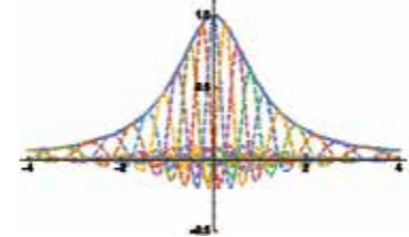
最近の研究で構成した高精度関数近似の例。実線が近似対象の関数、点線が近似を構成するための基底関数。
