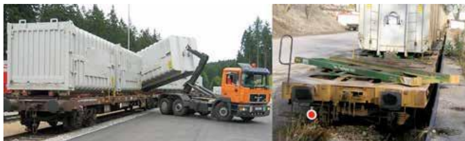
Fot. 1) Transport kolejowy z wymiennym nadwoziem opartym na systemie ACTS kontenerów rolkowych
