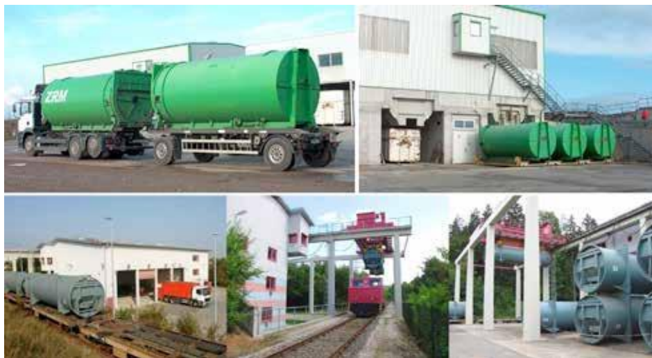
Fot. 3) przeladunek kontenerów transportowych systemu ACTS dla transportu kolejowego (na zdjęciu: system dostarczany przez firmę „Max Aicher”)
