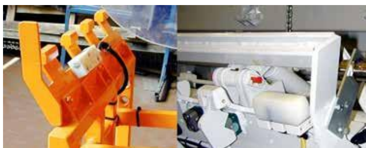
Fot. 2) Antena przymocowana do windy śmieciarki z ładunkiem tylnym. (Źródło: www.moba.de )
