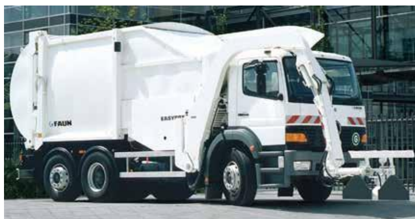
Fot. 3) wersja śmieciarki z załadunkiem przednim/bocznym (Źródło: www.faun.com )
