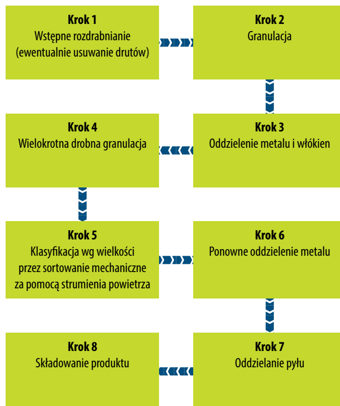
Rys.1. Przykład postępowania przy procesie mielenia zużytych opon na ciepło
