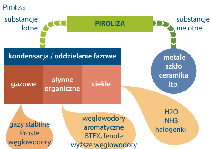
Rys. 2. Schemat pirolizy przy zastosowaniu sprzętu elektrycznego i elektronicznego
