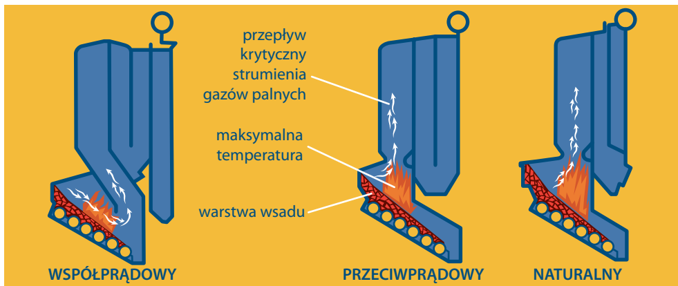
Rys. 1) Alternatywne wersje dystrybucji spalin w procesie spalania rusztowego
