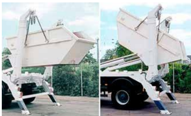
Fot. 1) Podstawowa wersja kontenera wymiennego i nadbudowa ciężarówki z procesem osadzania kontenera w pozycji osadzania oraz z procesem osadzania kontenera w pozycji zsypu (źródło: www.meiller.com )
