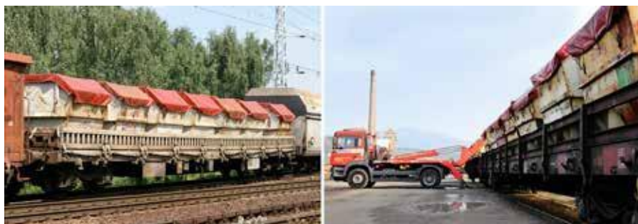
Fot. 6) System używający kontenerów muldowych w transporcie kolejowym . (Na zdjęciu: System dostarczany przez firmę „AWILOG”)
