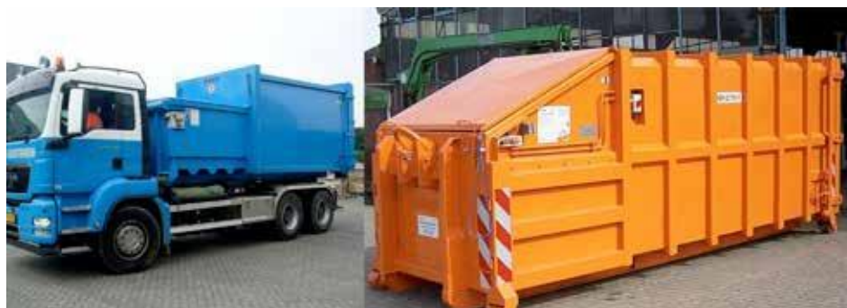
Fot 4) Kontener rolkowy ze stacjonarnym urządzeniem zgniatającym (źródło: http://www.brunns-umwelttechnik.de )
