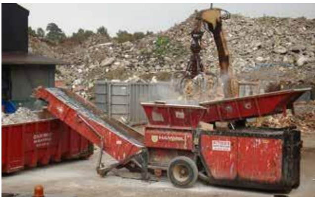
Rys.2. Mobilny przesiewacz kruszywa do odpadów budowlanych
