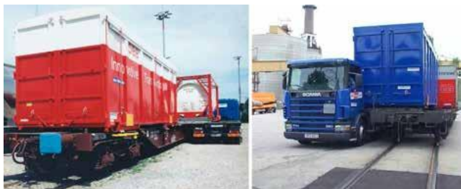
Fot. 5) Poziome przeladunek kontenerów transportowych w systemie wymiennego mostka (BDF) z samochodu ciężarowego na kolej. (Na zdjęciu: System dostarczany przez firmę „Palfinger Bermuller”)
