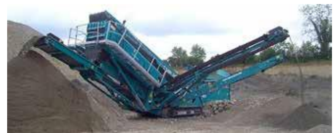
Rys.4. Klasyfikacja mieszanek mineralnych za pomocą agregatu Extec®
