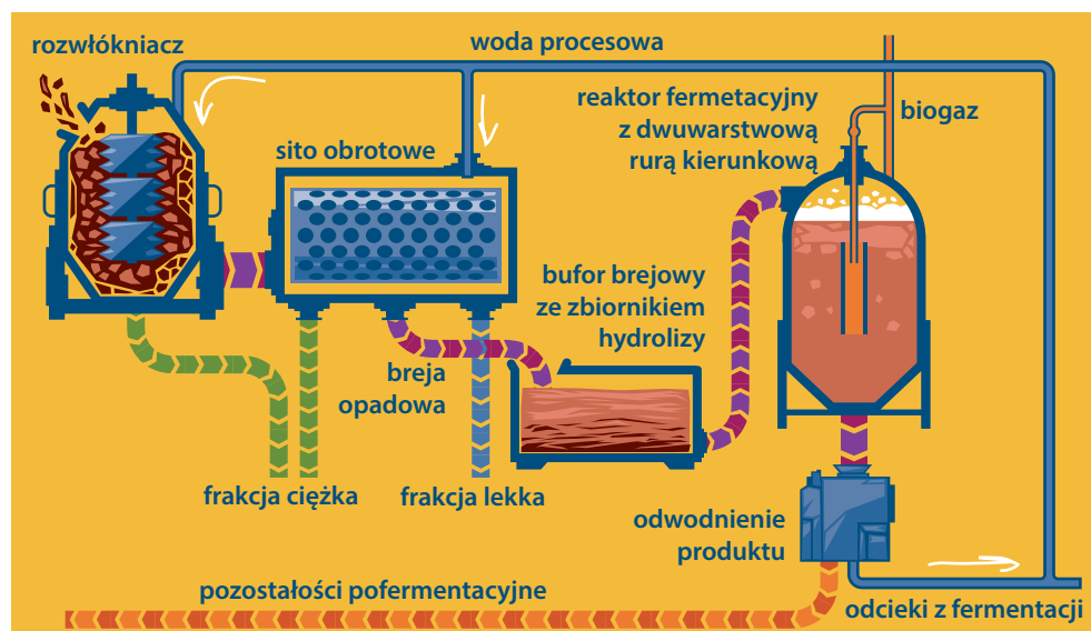
Rys 1: Możliwa konfiguracja mokrego procesu fermentacji
