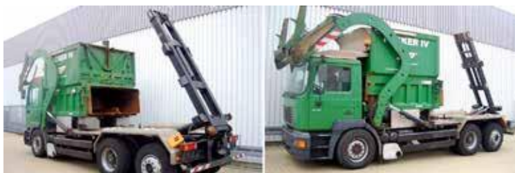
Fot. 1) śmieciarka z załadunkiem przednim z wymiennym kontenerem (Źródło: www.commonswikimedia.org )
