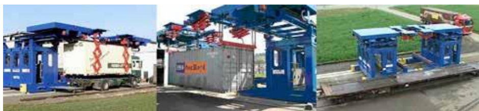
Fot. 4) System „Neuweiler-Tuchschnid-Horizontal” do przeladunku kontenerów transportowych w systemie wymiennego mostka (BDF) z samochodu ciężarowego na kolej. (Źródło zdjęcia: „Tuchschnid”)
