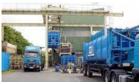
Fot. 2) Stacja przeładunkowa odpadów oraz dalekobieżne pojazdy transportowe z systemem kontenerów transportowych „Double-Basket”
