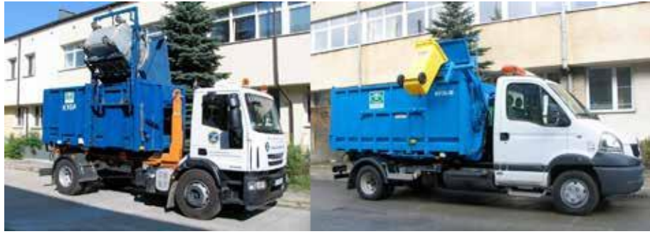
Fot. 3) Śmieciarka z załadunkiem bocznym niewyposażona w mechanizm zginiatania, używana m.in. do wywozu szkła (Źródło: mwm-brzesko.com.pl)
