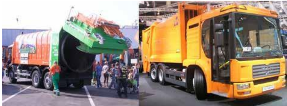
Fot. 4) Pojazd z obrotowym bębniem zgniatania i kabiną niskoprogową „Econic” (źródło: www.commons.wikimedia.org )
