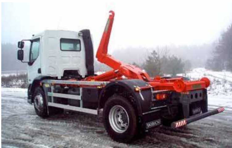
Fot 1) Nadbudowa pojazdów do przewozu kontenerów – baza z urządzeniem hakowym lub żurawiem (źródło: www.hms.com.pl )
