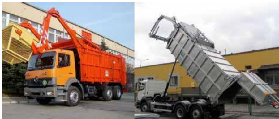
Fot. 2) śmieciarka z załadunkiem przednim o podwoziu zintegrowanym (Źródło: mwm-brzesko.com.pl )
