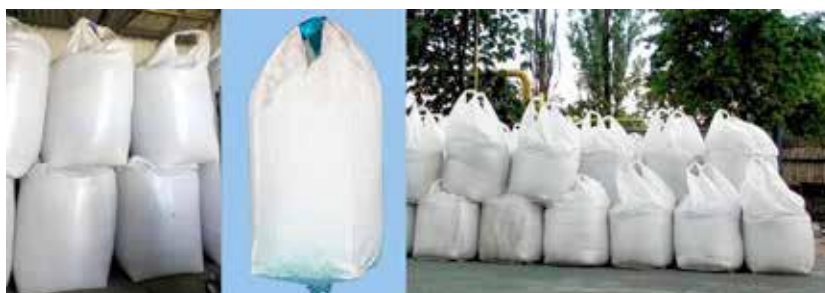
Fot. 2) Bigbag z pętlą do podnoszenia pojemnika (źródło: www.commons.wikimedia.org )
