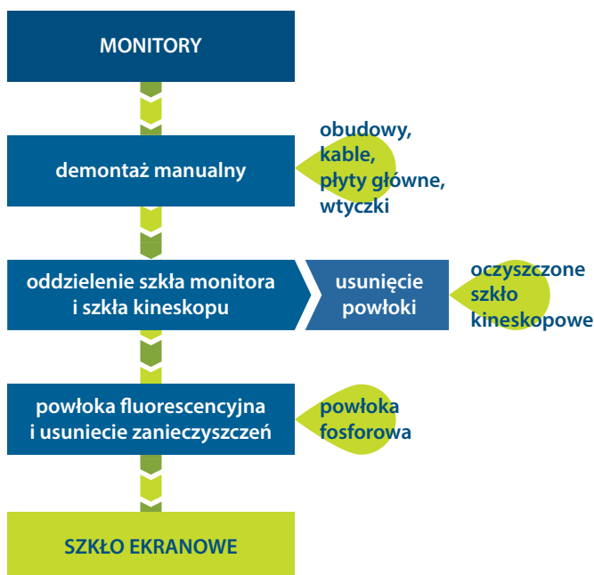
Rys.5. Uproszczony schemat przerobu monitorów
