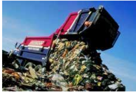
Fot. 4) Opróżnianie śmieciarki z ładunkiem tylnym przy pomocy płyty wypychającej (źródło: www.commons.wikimedia.org )
