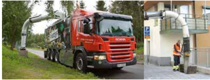
Fot. 2) Pojazd do próżniowej zbiórki podłączony do stacji dokującej zasysa zawartość bunkra do przechowywania odpadów. (Źródło: www.envac.de )
