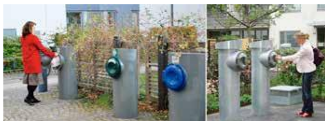
Fot. 1) Punkty zrzutu specjalnie zaprojektowane dla zbiórki pneumatycznej. (Źródło: www.envac.de )
