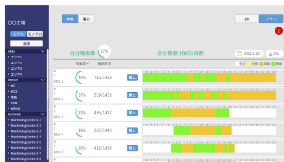
図15 工作機械の稼働状況を示したガントチャート
