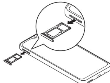
**3 USIMカードのIC（金属）面を下にして、USIMカード／SDカードトレイに取り付ける**
