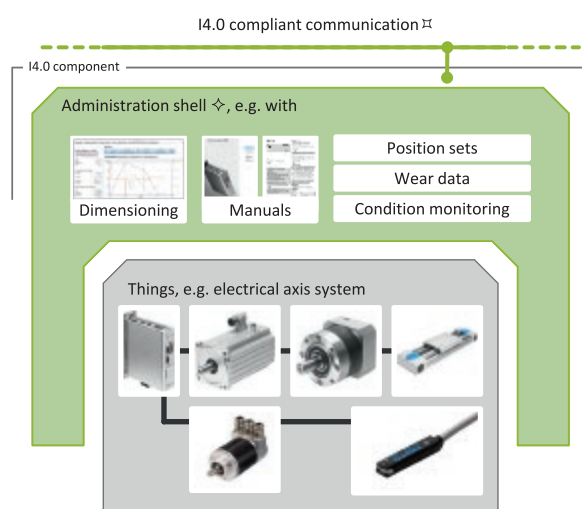
Figure 13. I4.0 component consisting of several objects Copyright „Umsetzungsstrategie Industrie 4.0 – Ergebnisbericht, Berlin, April 2015“
