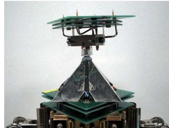
試験プラグ近端漏話測定の実例
