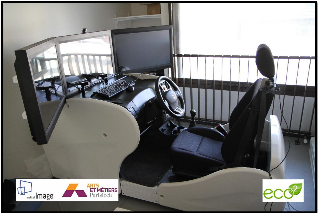
Figure 3 : Simulateur de conduite statique Eco 2
