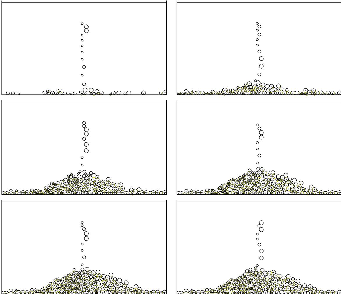
FIG. 4.6 – Déversement de particules soumises à la gravité ( $\tau = 5.10^{-4}s$ ,  $e_n = 0.1$ ,  $e_t = 1.0$  et  $\mu = 0.5$ ). Les particules sont générées tous les 10 pas de temps. La simulation présentée a demandé 3000 pas de temps : visualisation des efforts de contact normaux (en noir) et de frottement (en gris). L'épaisseur des traits est fonction de l'intensité des efforts de contact.
