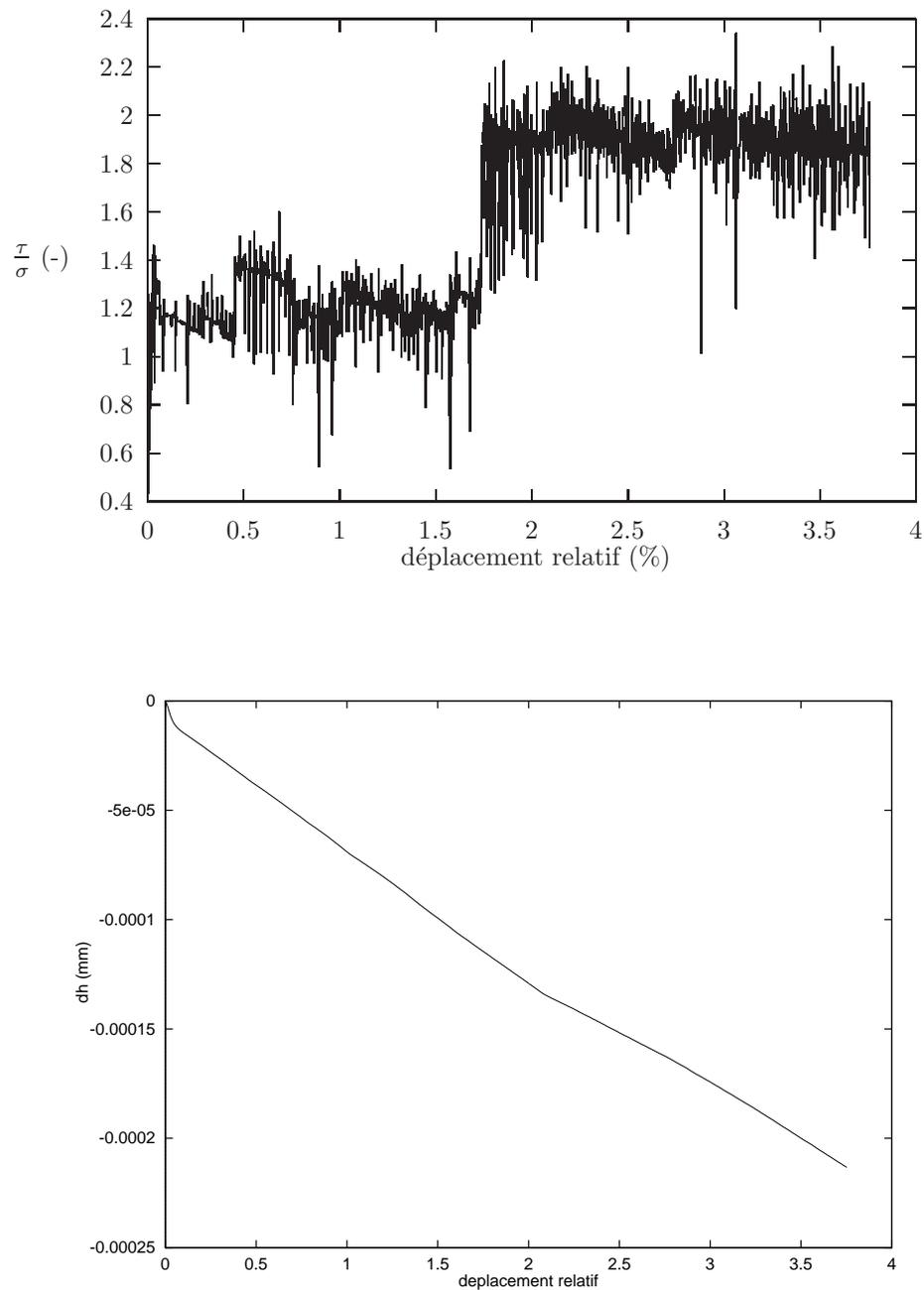
FIG. 4.21 – Résultats numériques d'un essai de cisaillement direct sur un échantillon de rouleaux polydisperses,  $\tau = 10^{-5}s$  et  $e_n = 0.1$ . La force sur le couvercle est égale à 400 N et la vitesse de déplacement de la boîte inférieure est égale à  $0.1ms^{-1}$  : variation de la contrainte de cisaillement et de la variation de hauteur en fonction du déplacement relatif de la boîte inférieure.
