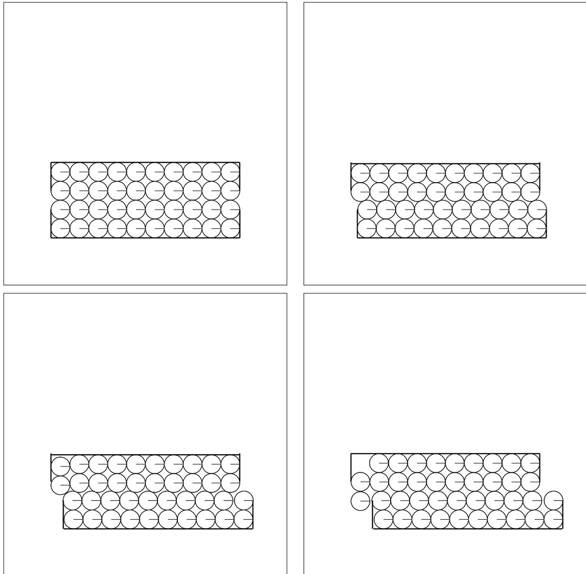
FIG. 4.17 – Simulation d'un essai de cisaillement direct sur un échantillon monodisperse :  $\tau = 5 \cdot 10^{-5} s$  et  $e_n = 0.1$ . La force sur le couvercle est égale à 60 N et la vitesse de déplacement de la boîte inférieure est égale à  $0.1 m s^{-1}$ .
