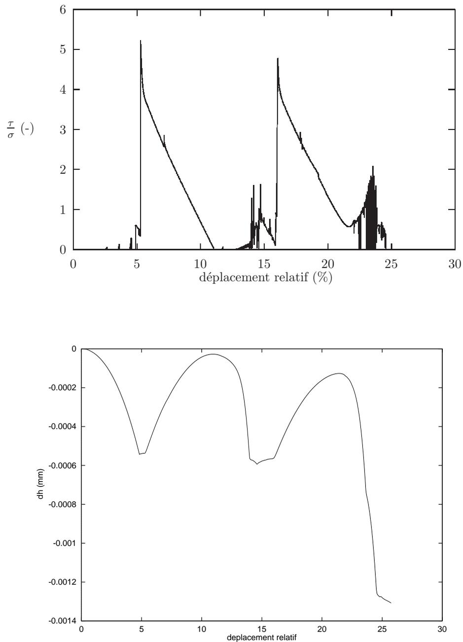
FIG. 4.19 – Résultats numériques d'un essai de cisaillement direct sur un échantillon de rouleaux monodisperses,  $\tau = 5.10^{-5}s$  et  $e_n = 0.1$ . La force sur le couvercle est égale à 60 N et la vitesse de déplacement de la boîte inférieure est égale à  $0.1ms^{-1}$  : variation de la contrainte de cisaillement et de la variation de hauteur en fonction du déplacement relatif de la boîte inférieure.
