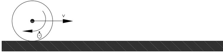
FIG. 3.4 – Roulement d'un cylindre sur un plan horizontal : contact maintenu sans variation de l'effort normal  $N$ .
